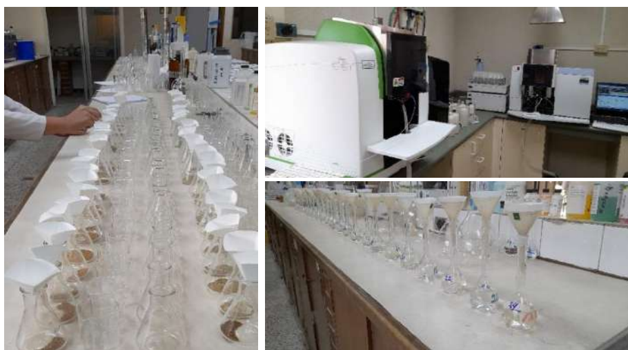
Procesos para la determinación de elementos químicos del suelo y parte de los equipos empleados.
